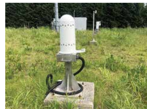
空間の放射線量(空間ガンマ線量率)を 測定するための装置(環境研敷地内)
