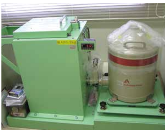
放射性セシウムなどを 分析する装置 (ゲルマニウム半導体検出器)
