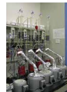
環境中のトリチウムを分析するための前処理装置群
