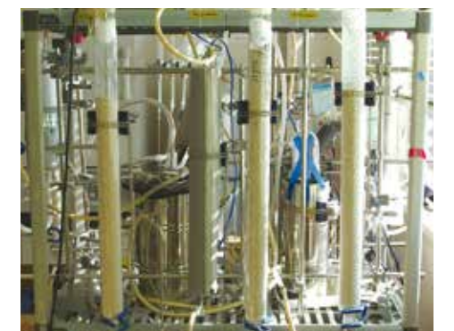
環境中のトリチウムを分析するための前処理装置群
