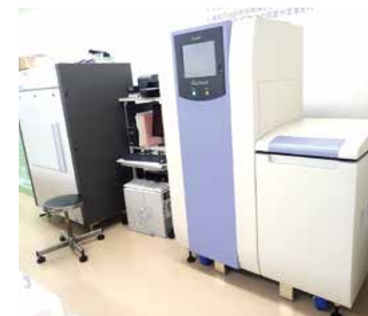
トリチウムなどを 分析する装置 (液体シンチレーション カウンター)
