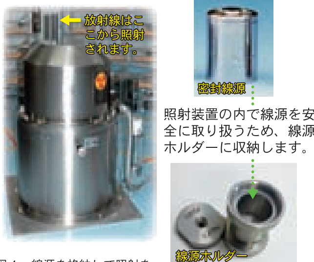
図4 線源を格納して照射を止めます
