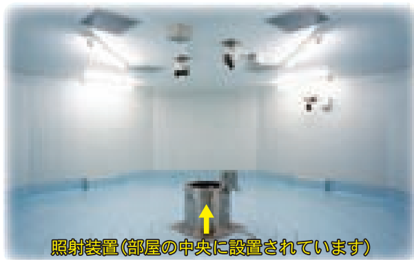
図2 八角形の床。放射線を均等に当てるための工夫です。
