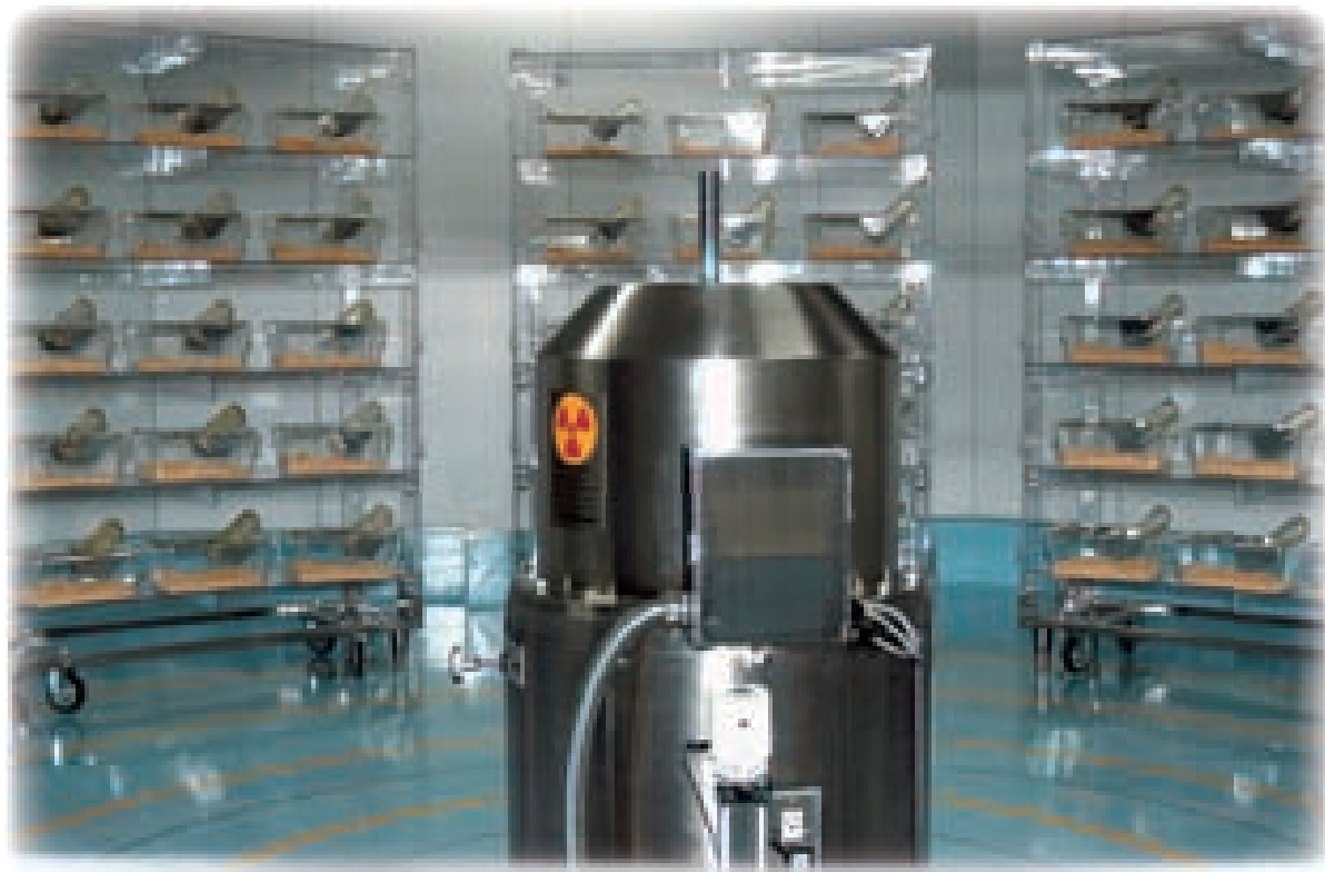
図1 放射線照射室の様子(先端分子生物科学研究センター) 壁際の棚で実験動物(ネズミ)を飼育しながら、放射線をあてています。
