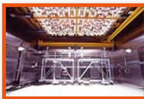
図2 全天候型人工気象実験施設内の大型人工気象室(左上)は、様々な気象を再現して野外ではできない実験を行うことができます。
