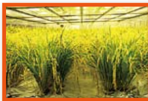
図3 閉鎖型生態系実験施設では農産物を播種から収穫まで栽培できる部屋(左上)があります。また部屋は密閉できるため、空間で循環するガスの量や物質の移行・蓄積を正確に測ることができます。
