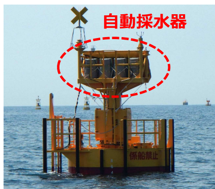
係留式ブイ 1.5m深より2時間間隔で採水
