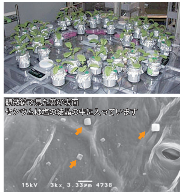
図2 ダイコンの葉にセシウムを沈着させます (実験風景)
